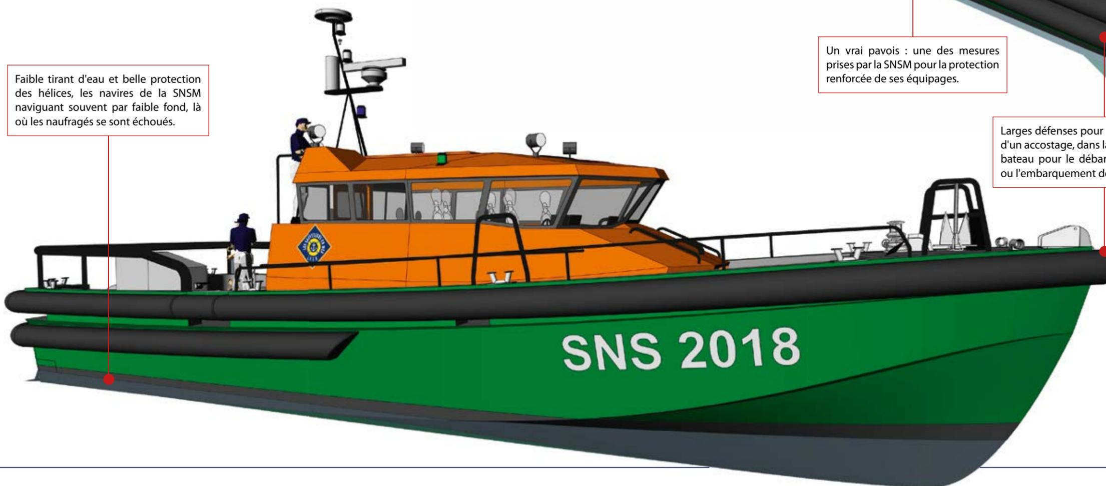
Faible tirant d'eau et belle protection des hélices, les navires de la SNSM naviguant souvent par faible fond, là où les naufragés se sont échoués.
