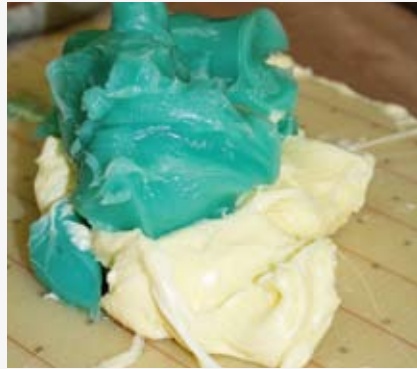
Résine chargée et catalyseur (en jaune) vont constituer le joint proprement dit.
