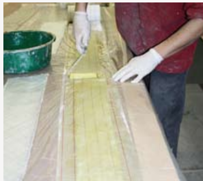
Imprégnation en résine de la bande de tissu bi-biais destinée au corniéragé.
