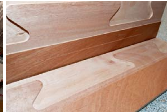
Découpés numériquement également, les scarffs des bordés permettent de les maintenir ensemble.
