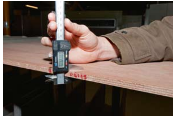
Épaisseur 12 mm confirmée ! Bordés, cloison, tableau arrière avec la même épaisseur sauf le fond.
