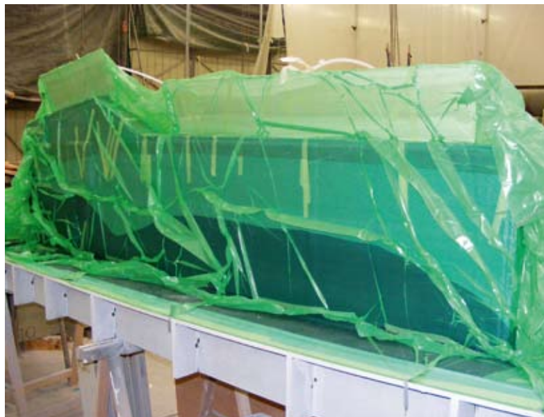
Le puits de dérive demeure la pièce en composite du bateau. Il a été réalisé selon le procédé d'infusion.
