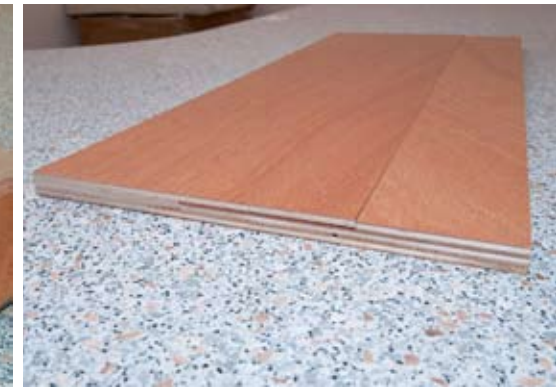
Exemple de panneaux scarffés : on ne voit rien et l'ensemble est propre et rigide .
